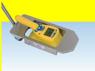
CoMo in a floor control device
